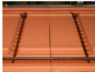
Segue il prelievo automatico dei fondelli di lunghezza 25 e 30 cm e il loro posizionamento sui due nastri di alimentazione. Pinze automatiche sollevano i fondelli e li inseriscono sul nastro trasportatore della linea di produzione: il numero di fondelli varia a seconda della lunghezza richiesta per il travetto. Successivamente, i fondelli vengono bagnati con dell'acqua, al fine di evitare un possibile assorbimento della stessa dall'impasto ad opera del fondello.
