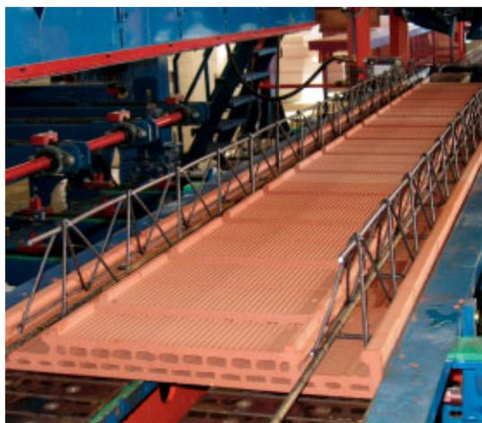
Segue la fase che caratterizza in modo determinante l'Eurosolai®: su ogni fondello viene inserita una barra posta perpendicolarmente alle armature longitudinali interne.
