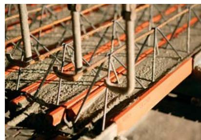
A questo punto si procede allo sbanco con pinze elettromeccaniche, mediante l'aggancio in 6 punti su ogni singolo traliccio, ed alla realizzazione delle cataste; esse vengono trasportate tramite muletto nella zona di stoccaggio, dove la successiva sosta garantisce la completa maturazione del getto ed il definitivo controllo della qualità dei manufatti.
