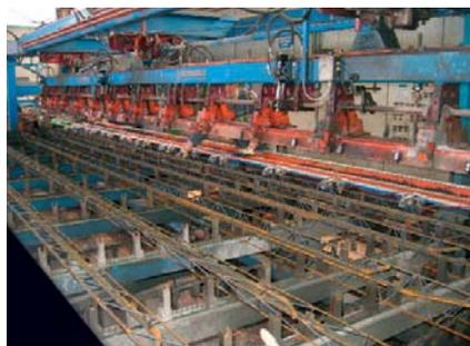
Successivamente, i tralicci e l'eventuale armatura aggiuntiva interna al travetto vengono posizionati su un dispositivo esterno al carosello, dal quale un sistema di pinze automatiche li preleva e li dispone all'interno del fondello; il fondo così predisposto avanza fino alla stazione di getto della malta con benna superiore fissa, collegata all'impianto di betonaggio.
