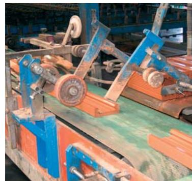
Ogni travetto viene marchiato mediante spruzzatura automatica di inchiostro al passaggio dei fondelli.
