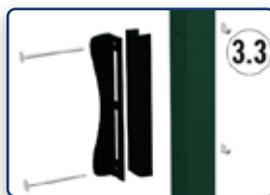
3.3 Installa la controserratura ed il battente nella modalità di apertura desiderata
